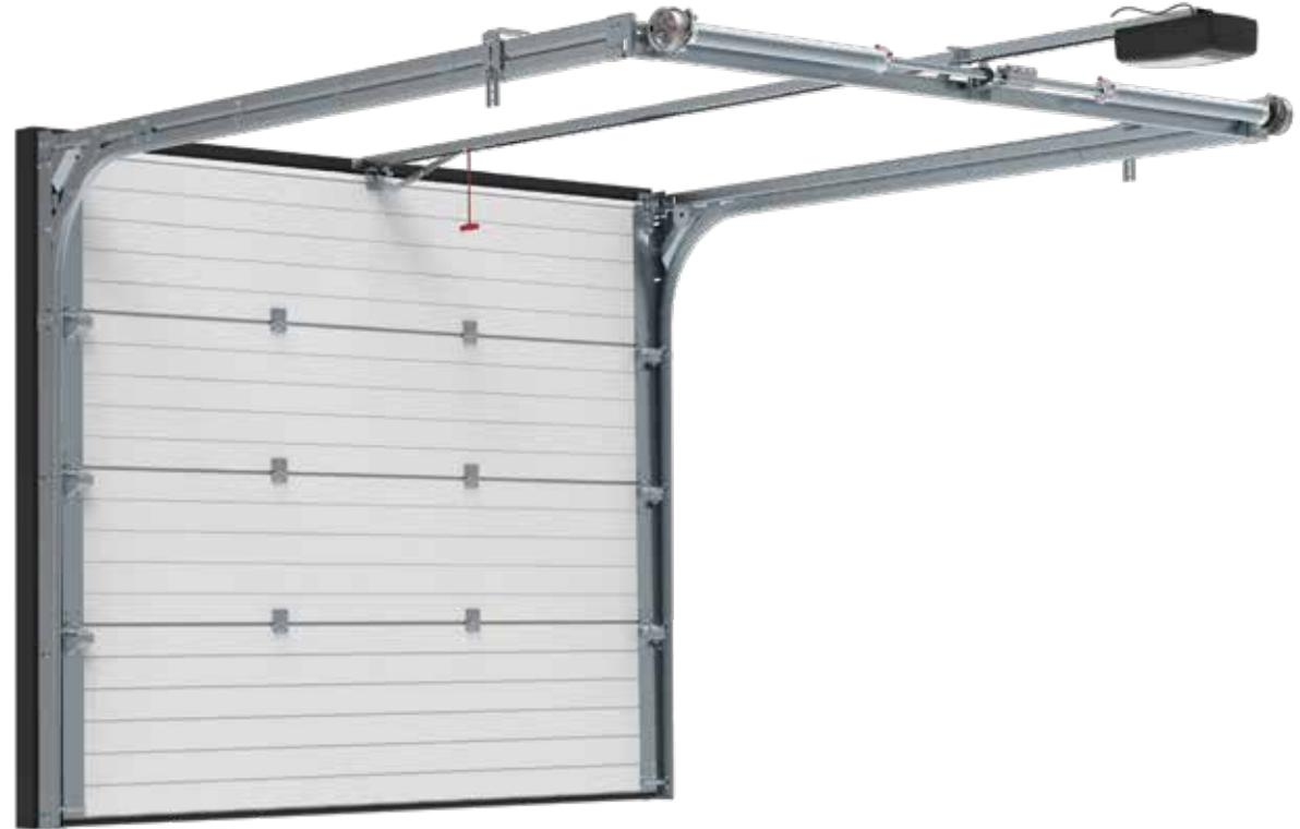
Unsere Torsionfederwelle hinten ist die richtige Wahl, wenn die Einbauhöhe begrenzt ist. Das System benötigt einen Sturzfreiraum von 100 mm. Die Torsionsfedern sind am Ende der Horizontalschiene angebracht.
