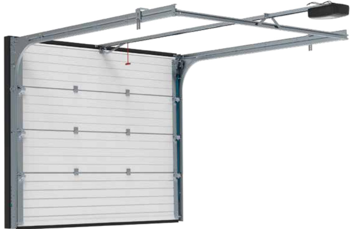
Die Zugfedertechnik ist ein Schienensystem, das nur einen Sturzfreiraum von 100 mm benötigt, aber mit Zugfedern anstelle von Torsionsfedern ausgestattet ist. Die Zugfedern sind in den vertikalen Schienen angebracht. Dank der vorgespannten Federn ist eine schnelle Montage dieses Systems gewährleistet.
